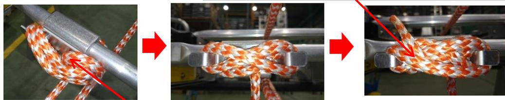
ロープ端末をクリートとロープの間に差込み
