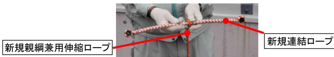
4-12: 4-9で取外したボルト、ナットを用いて、新規連結ロープの末端を固定します。
