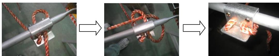
※クリートタイプの端末金の場合は、下の写真の状態にして、端末処理を行なってください。
