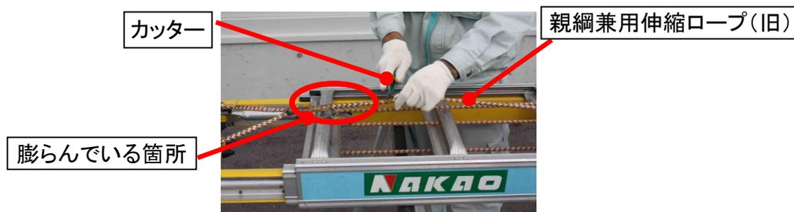
4-8: カッターで連結ロープの先端2ヶ所を切断します。
