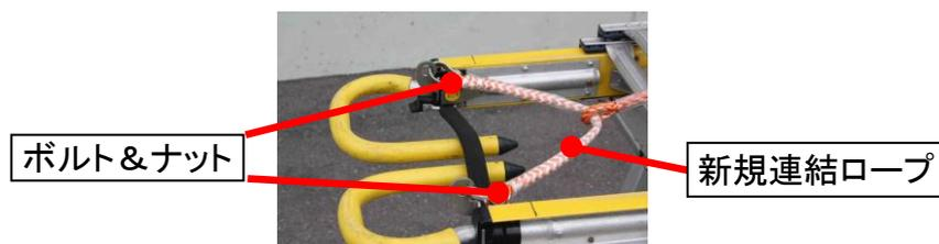
4-13: 4-7で切断した親綱兼用伸縮ロープの末端と新規の親綱兼用伸縮ロープの末端をビニルテープで連結します。
