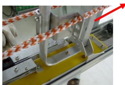
※新タイプ及びクリートタイプの端末金の場合は、下の写真の状態にして、古いロープを矢印の方向に引張り出してください。
