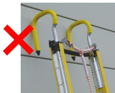
**警告** 安全フックを柱間(背面)電柱方向に向けた状態で、壁面に立て掛けないでください。
