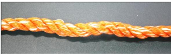
ロープの編みこみ模様が不規則で浮き沈みがあるものは、安全器の作動・ロックに影響がでます。
