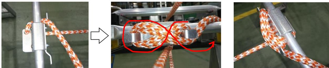
3. はしご縮長状態で、下図の様にグリップを側面方向に軽く引張り、グリップが下はしご支柱にギリギリ乗る程度の張り具合となる様、2の操作を繰り返して調整してください。
